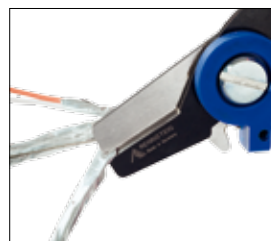
Schneiden der Paarschirmung Cutting the double shielding
